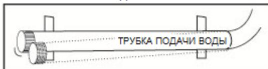
1 Шаг: Снять трубку подачи воды с испарителя
