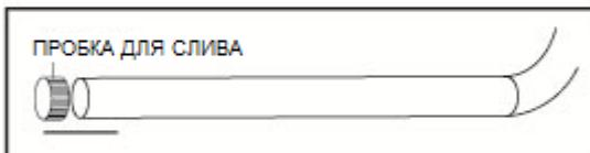
2 Шаг: Снять пробку для слива воды с трубы
